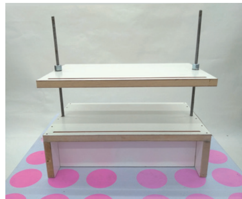
圖3 郭家宏、李昇祐、賴雯淑，打洞、縫書、壓書三合一作書工具，2017。照片：賴雯淑
