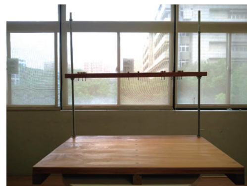
圖4 李昇祐、郭家宏、賴雯淑，自製縫書台。縫書台是縫製西式書籍必備的支撐框架。2012。照片：賴雯淑
